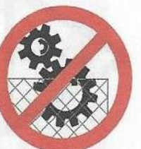
Vietato rimuovere le protezioni
